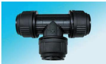
Il tubo deve essere adeguatamente preparato ed inserito nel raccordo (fino in fondo), ruotando il corpo a vite di circa 1/4 di giro (si sentono 2 scatti) si blocca la pinzetta in posizione e si ottiene un'ulteriore compressione dell' 'O' ring sul tubo. Si noterà che bloccando la pinzetta in posizione si riduce il movimento laterale e obliquo del tubo.
