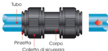
Anche questa misura ha una pinzetta con denti in acciaio inox ed un 'O' ring per garantire il massimo aggraffaggio e tenuta. Il raccordo può essere smontato e riutilizzato senza bisogno di sostituire alcun componente.
